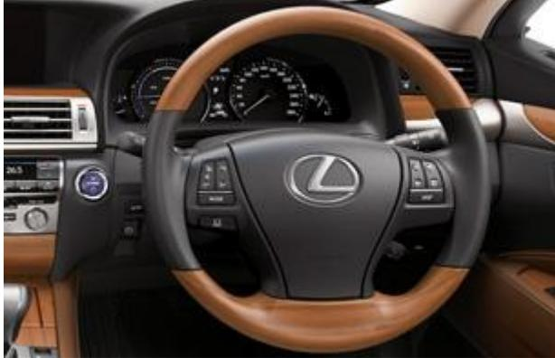
この製品では、竹に曲げ積層加工を施し、意匠曲面と木目を統一させることで意匠性を向上させる事に成功している。
